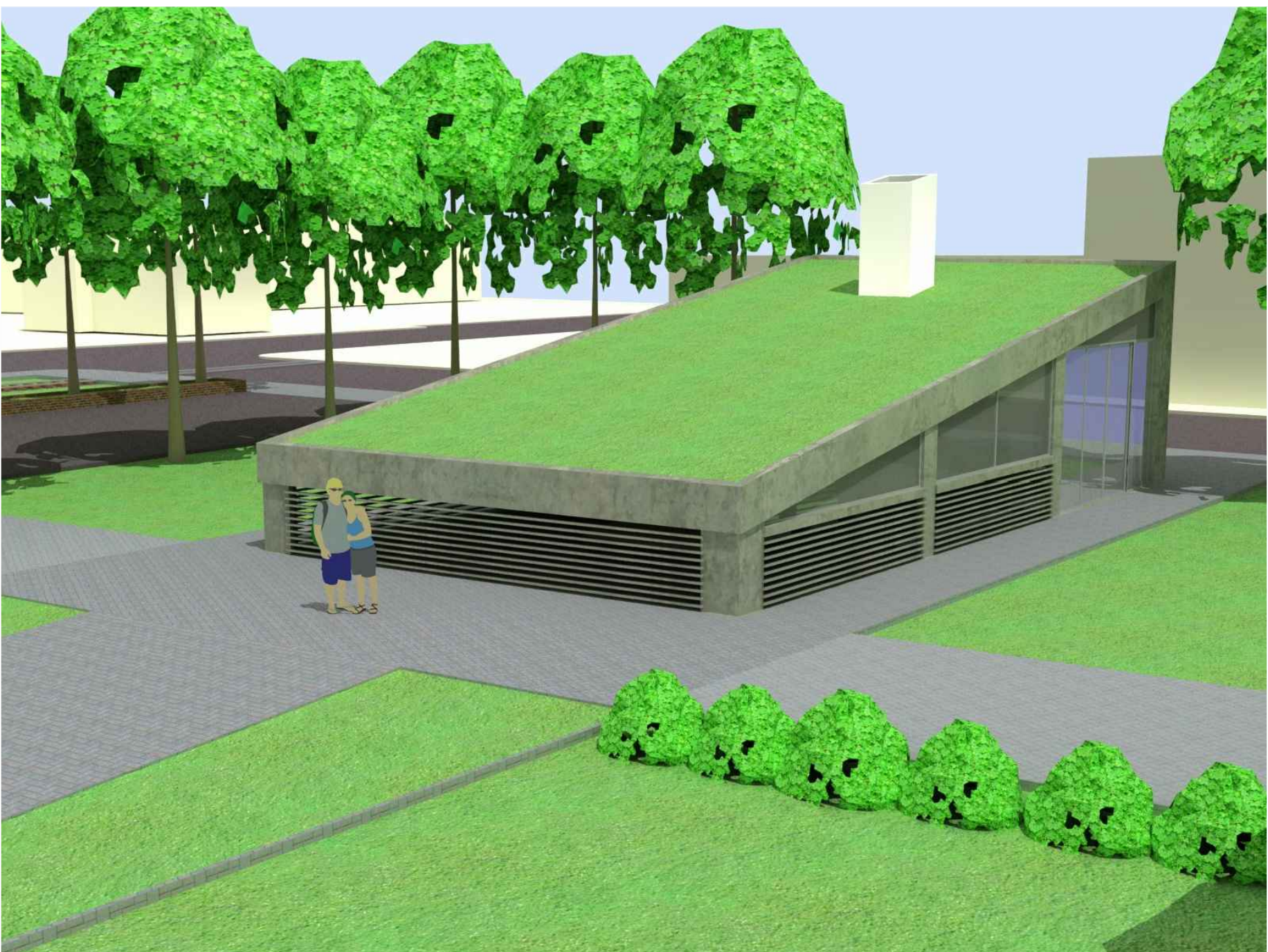
A cobertura é essencial para o funcionamento do forno noborigama, pois com as possíveis chuvas ela iria resfriar o forno, prolongando o tempo da queima.
